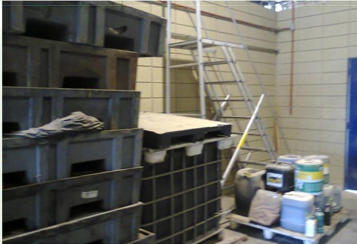
Resíduos perigosos armazenados de forma incorreta, impedindo a passagem e causando risco de acidentes.
