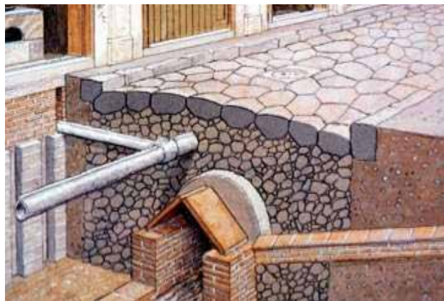
FIGURA 43 – INFRAESTRUTURA DE SANEAMENTO SOB O PAVIMENTO DAS RUAS DE ROMA
