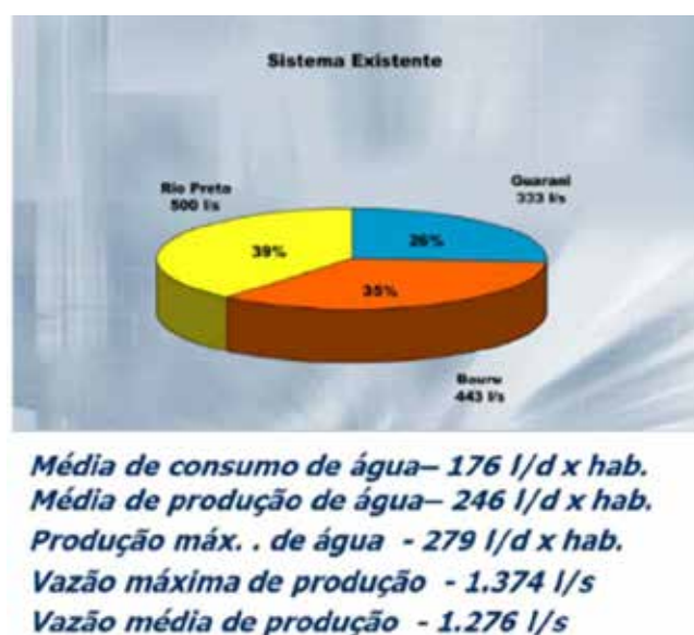
FIGURA 183 - CARACTERÍSTICAS DO SISTEMA DE ABASTECIMENTO DE ÁGUA EM 2008
