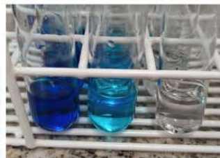
Figura 6: Capacidade de adsorção de azul de metileno: A) H 3 PO 4 ; B) CO 2 .
