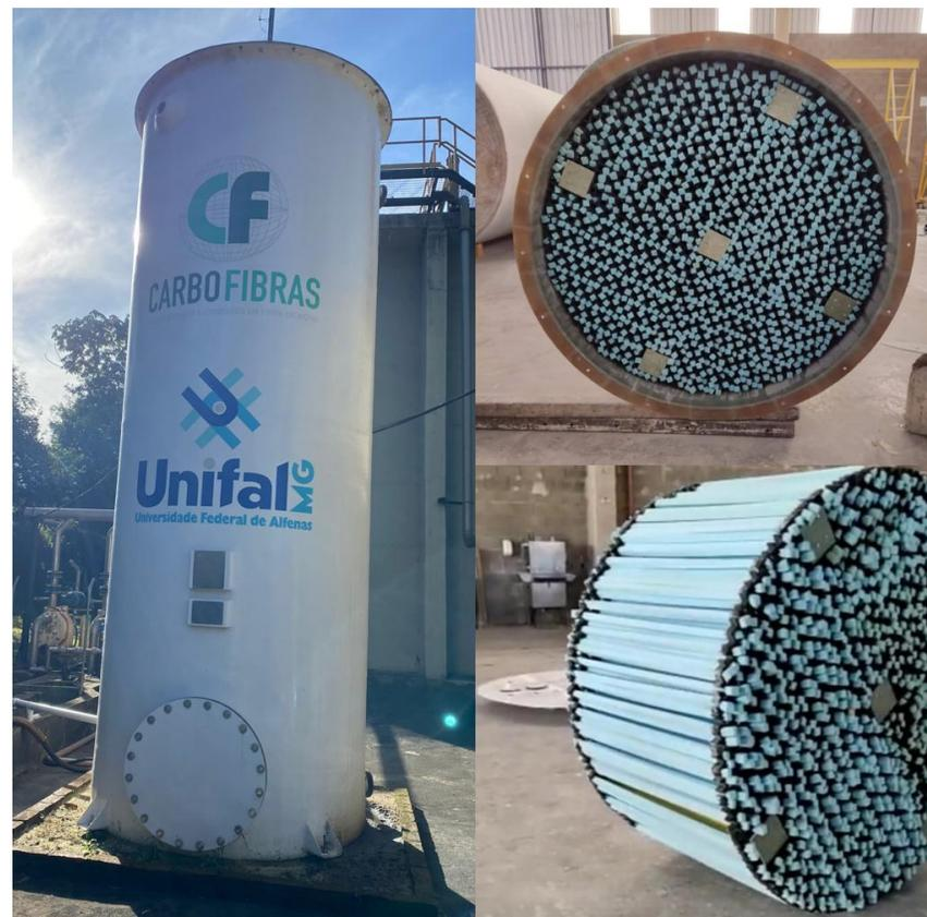
Figura 2: Reator e material de preenchimento.
